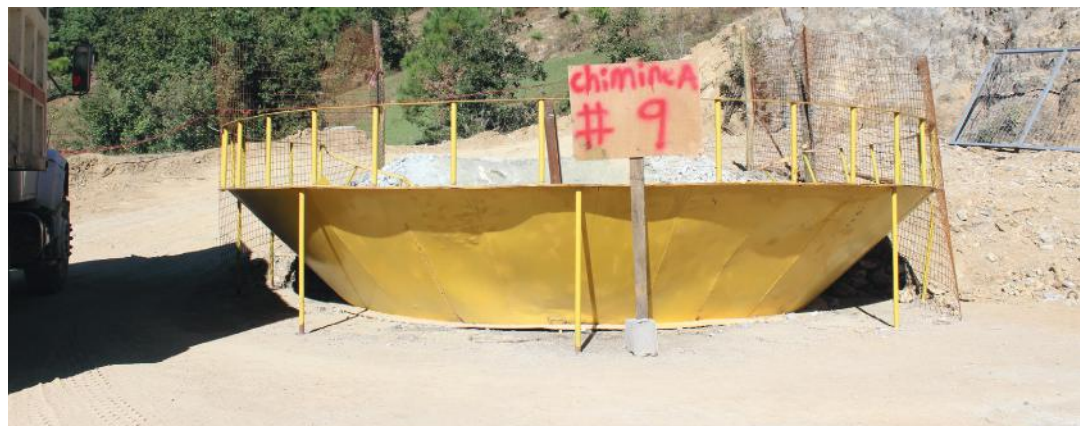
Por medio de estas chimeneas se introducía aire fresco para los trabajadores mineros.
