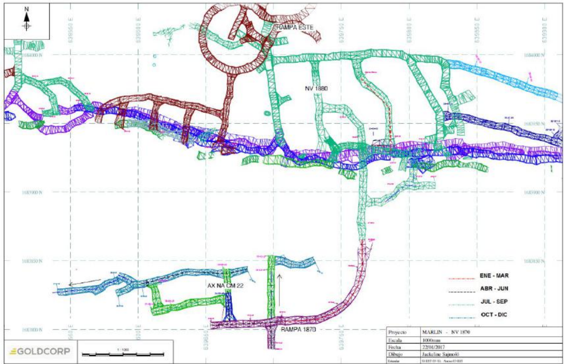
Plano 8. Detalle de avance NIVEL 1870
