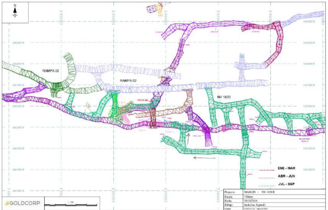
Plano 7. Detalle de avance NIVEL 1830E
