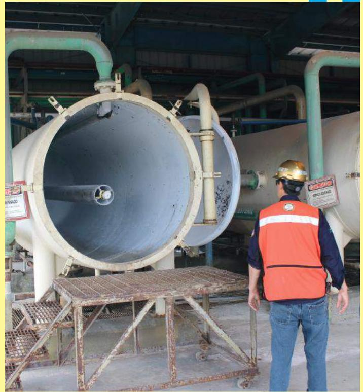
Roldán verifica el estado de la maquinaria y equipo del circuito Merrill Crowe, parte del proceso hidrometalúrgico.
