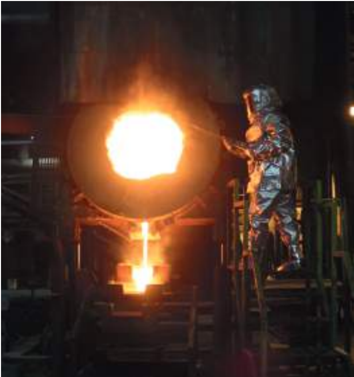
Los metales fundidos llenaron por última vez los moldes de las barras doré, la mezcla de oro y plata.
