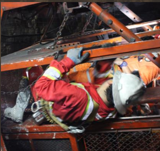
El personal evacuado entra a la jaula de forma horizontal, la cabina tiene capacidad para 6 personas.
