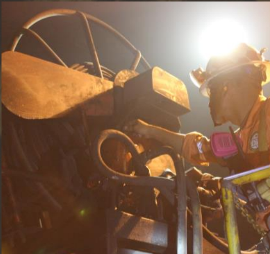
La jaula es operada por un mecanismo de cremallera o zíper, similar al de los elevadores.
