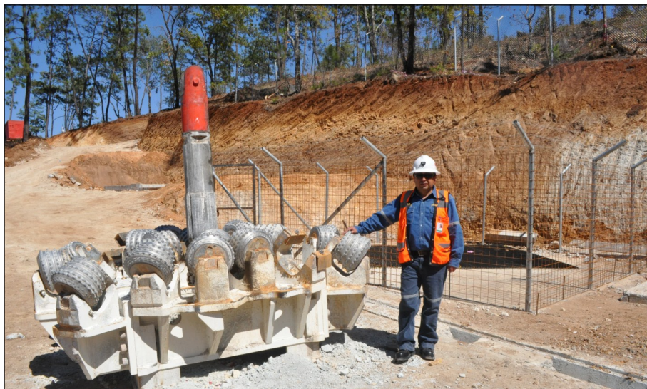
El ingeniero Luis Quiñones, supervisor de Ingeniería de la Mina Marlin, junto a la fresa de perforación de 3.1 metros, al fondo la primera chimenea culminada.
